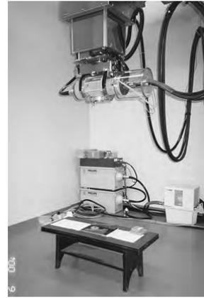
写真2 X線発生装置
